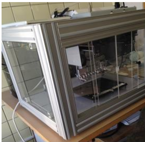
Рис.36. Наноплоттер для бесконтактной «печати» микропятен на дне лунки микропланшета (скорость нанесения – 1 мин/планшет), ГосНИИ БП, Москва.
